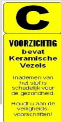
Für **keramisches Fasermaterial** gelten dieselben Vorbeugemaßnahmen wie für Asbest.
